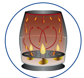
Öl- und fettfreies Frittieren durch Heißluftzirkulation
